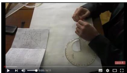
Видео 3.6 – Нанесение речных точек на топографический план:
